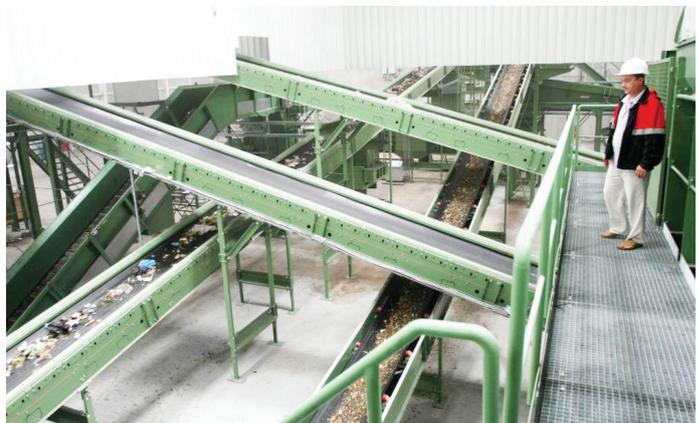
*Обновленная линия сортировки коммунальных отходов на Брестском мусороперерабатывающем заводе (МПЗ) заработает до конца ноября. Ее работа будет усовершенствована благодаря новому оборудованию: трем оптическим и одному баллистическому сепараторам.*
